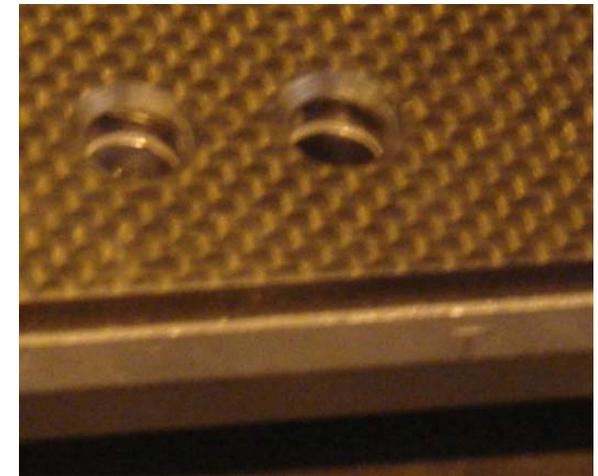
Nécessité de détournage pour retirer la bavure et réaliser des ouvertures sur la pièce
